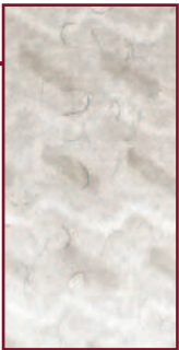
Znak wodny w papierze niewykazującym luminescencji w promieniowaniu ultrafioletowym (Watermarked Security „Vlnovky”-120g/m 2 )
